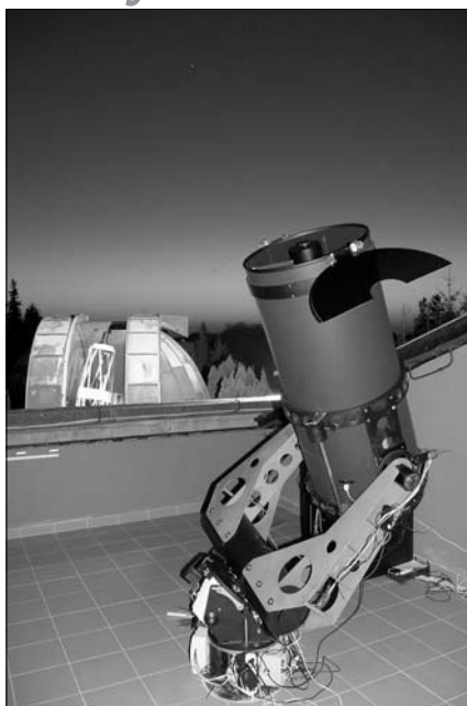
Az 50 cm-es Ritchey-Chrétien távcső, háttérben a 60 cm-es Cassegrain-teleszkóppal
