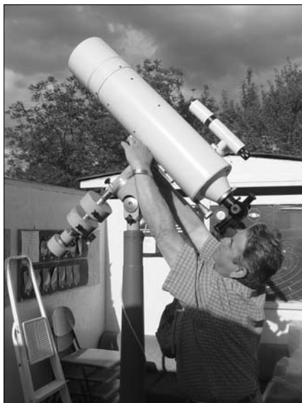
A kőszegi Városi Csillagvizsgáló főműszere egy 150/2250-es Zeiss Meniscas. A távcső mellett: Vértes Ernő
