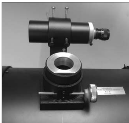
Az új, 50,8 mm-es okulárok fogadására is alkalmas okulárkihuzat
