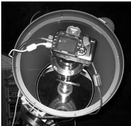
Canon DSLR egy 14 hüvelykes SC primér fókuszában, a Starizona Hyperstar adapterrel
