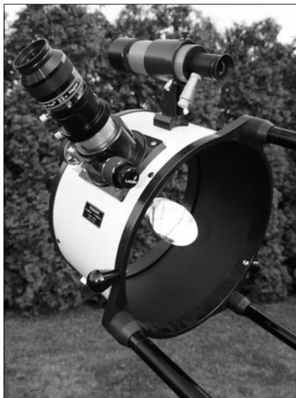
A felső tubusvég; az okulákihuzat egy 22 mm-es Nagler-okulárral megterhelve
