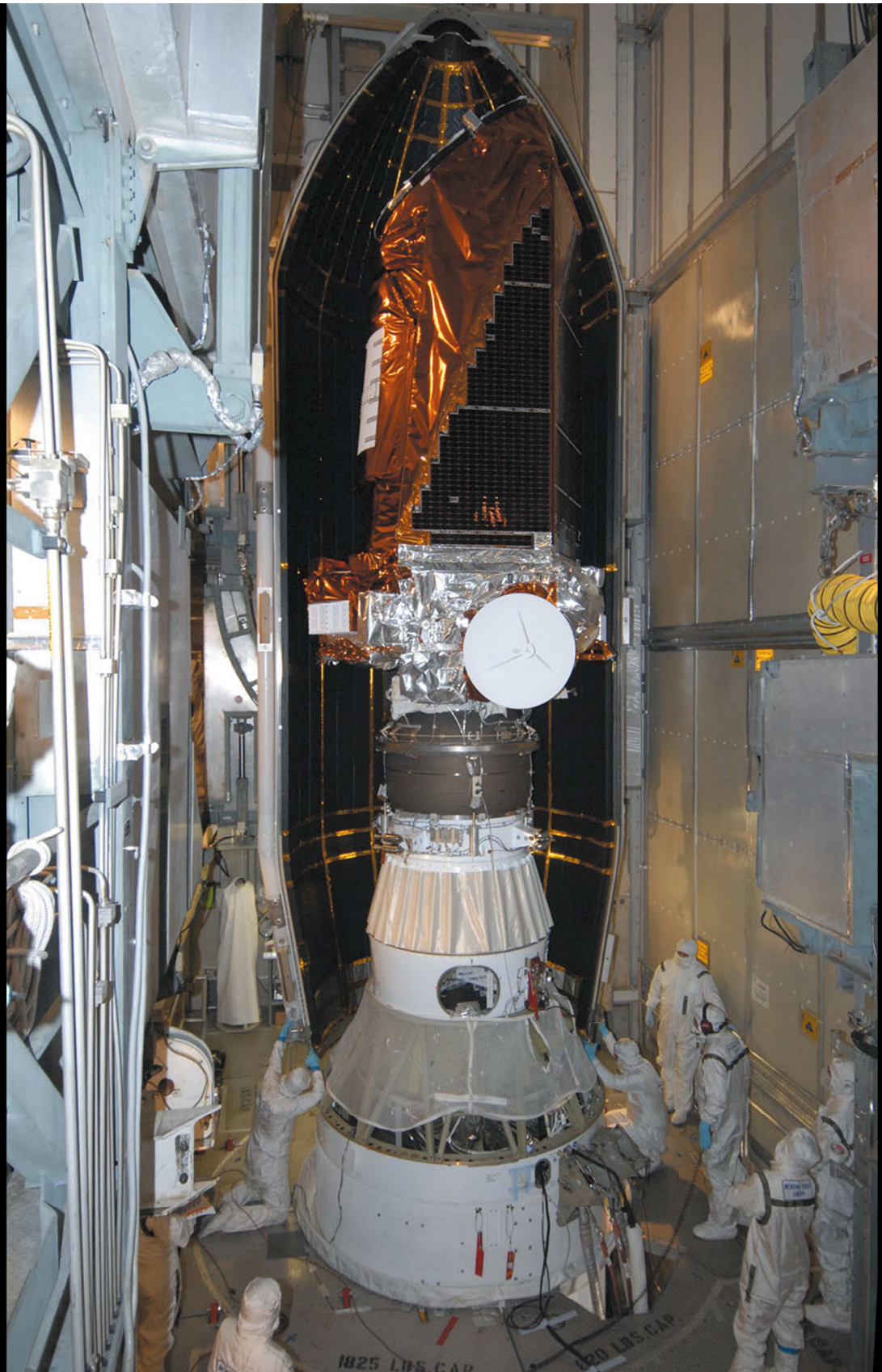
A technikusok felhelyezik a Kepler-űrszondát védő orrkúp egyik felé a floridai Cape Canaveralon. Bővebben I. cikkünket a 11. oldalon!
