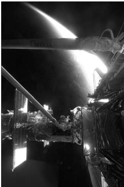
Az Atlantis robotkarja által befogott és a raktérben rögzített HST – háttérben a földsról
