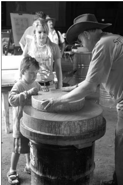
Egy 68 cm-es tükör helyszíni csiszolása. A találkozó szervezői komolyan veszik az utánpótlás nevelését
