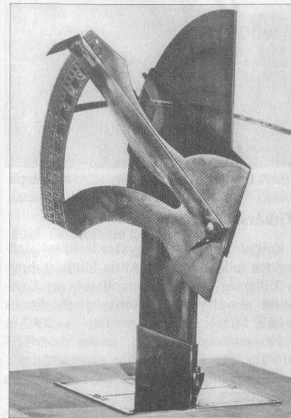
Pühler Kristóf Gallusnak nevezett műszere, földrajzi hosszúság mérésére. Az 1560 körüli tervrekonstrukciója (Fleck Alajos útmutatásai nyomán)
