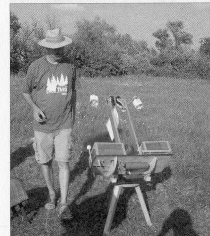
A találkozó egyik érdekessége volt Mucsi Dezső tükrös binokulárja, mely 2 db 200/930-as főtükörrel készült, és 30–100x-os nagyítással használható
