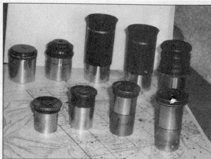
A hátsó sorban: 6,7 mm-es Meade Plössl, 6 mm-es japán orthó, 6 mm-es Synta GL, 9 mm-es Synta GL, 17 mm-es katonai Erfle. Az első sorban: 24,5 mm-es okulárok: 5 mm-es Vixen orthó, 17 mm-es orthó (mikroszkóp-okulár), 6 mm-es Vixen orthó, 10 mm-es cseh Erfle (ATC)
