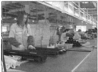
Tasco távcsövek a gyártósoron. Egy kész távcső kb. félpercenként „gördül le” sorról
