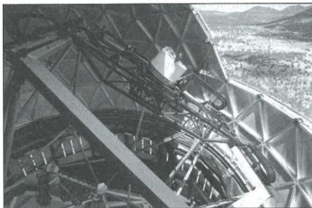
A HET „óragépe” a távcső forgatásából és a primer fókuszba szerelt mozgatómechanizusból tevődik össze. Balra lent láthatók a felvétel idején még félig kész tükröszegmensei
