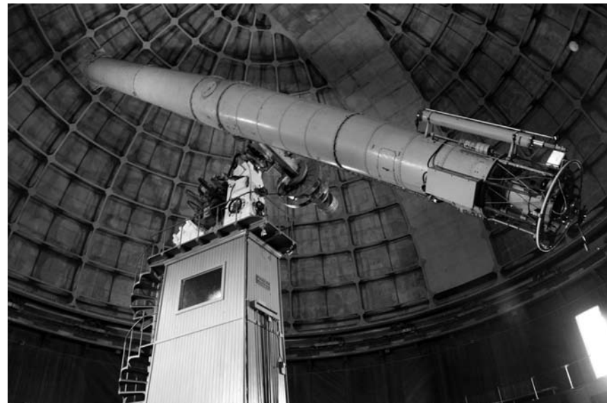
A Lick Obszervatórium 91 cm-es refraktora
