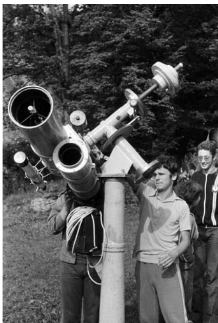
A rókafarmi tábor legnagyobb műszere volt ez a 175 mm-es Cassegrain-távcső (mellette Sáfár József látható)
