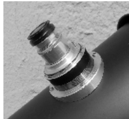
Az okulárkihuzat. A 20 mm-es Plössl is darabokra szedhető, amely a kihuzatban van, így amolyan próbaokulár. Olcsó példány, nem volt márkajelzése sem, foglalatát esztétikussá átalakítottam. Alkalmassint az okulár és a korrektor távolságát is változtatni kell, ezért van rá szükség. Ezt a példányt hozzáteljesítésre is használok, optikai tulajdonságait már kiismertem a rendszeresen használt távcsöveimmel
