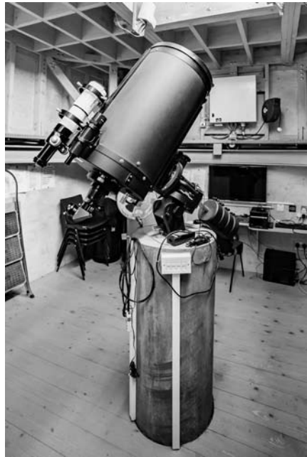
Az obszervatórium 40 cm-es, Meade gyártmányú Schmidt-Cassegrain-távcsöve
