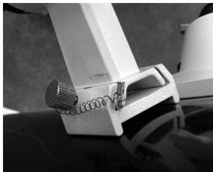
A keresőtávcső tartólábát fémtisztára csiszoltam, hogy az apró csavarra biztosabban meg tudjam szorítani
