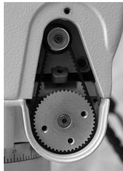
Közelkép a bordásszj-hajtásról
