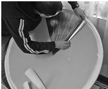
A napkályha készítésének kényes fázisa a tükröző fólia felragasztása
