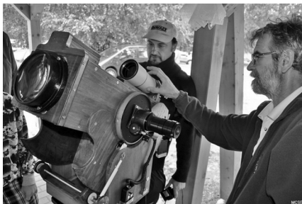
A távcsőépítő mozgalom éll! Újvárosy Antal összehajtott fénymenetű 15 cm-es refraktora a 2013-as MTT-n (Búza Katalin felvétele)
