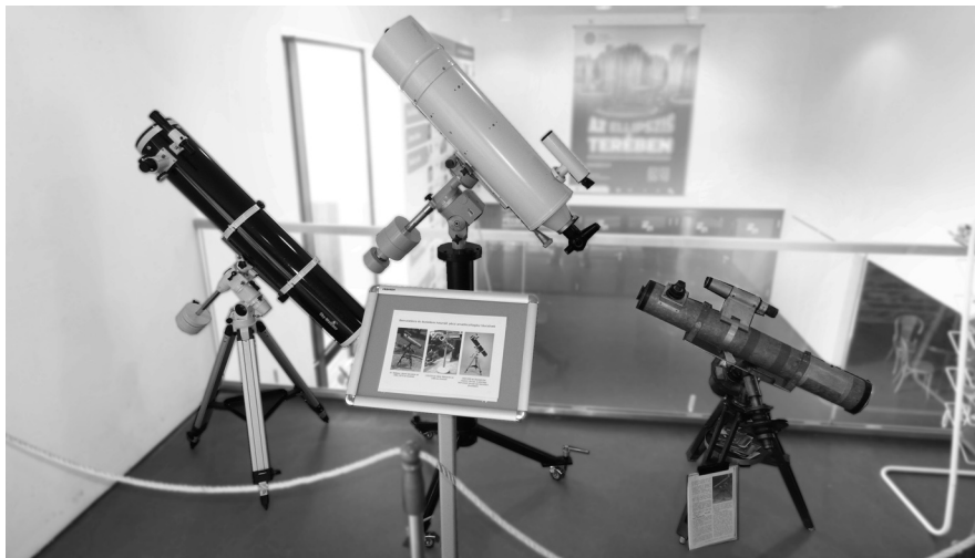
Múlt és jelen a pécsi Zsolnay Kulturális Negyed Planetáriumában 2. Jobbra: Balázsny László saját készítésű, a Hobbyam: a csillagos ég filmben is szereplő távcsöve, amivel számos kiváló asztrofotót készített és sok távcsöves bemutatást tartott a nagyközönségnek. Középen: 150/2250-es Zeiss Meniscas, ami az 1980-as évektől a pécsi észlelések és bemutatások egyik legfontosabb műszere volt. Balra: a jelenleg leginkább használt bemutató távcső (150/1200-as Skywatcher, az Astrotech ajándéka). Gyenizse Péter felvétele
