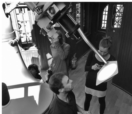
Napkivetítés a 15 cm-es Zeiss-Coudé refraktorról
