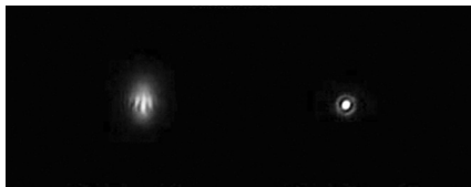
A legfényesebb éjszakai csillag képe balra korrektor nélkül, jobbra korrektorral (A kép szélsőséges, de előforduló esetet mutat)
