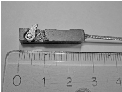
A szerkezet egyik legkisebb része alig 2,5 cm-es egység, ehhez csatlakozik a bowden. Maga a kilincsnyelv kb. 6 mm-es
