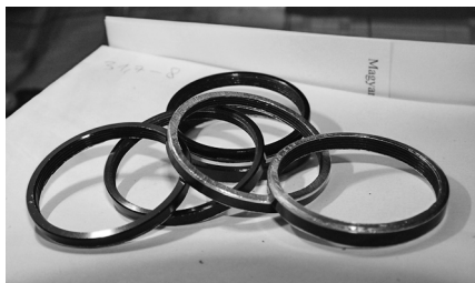
A belül szűrőmenetes cső felarabolásához egy törött fűrészvárcsát használtam esztergakésként
