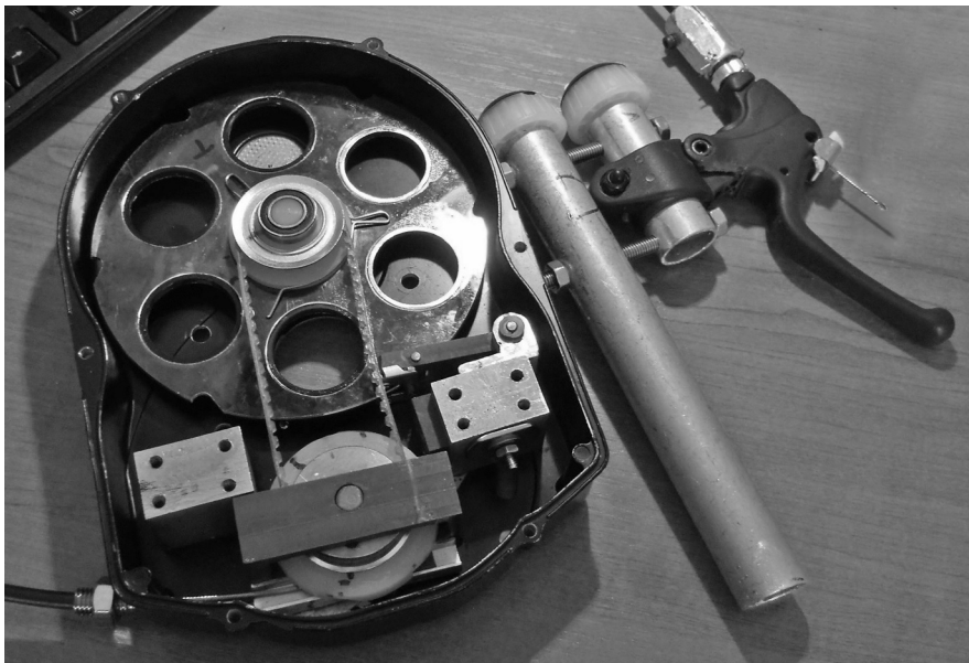
A szerkezet összeszerelve. Jól látható a revolverkerék, annak szíjhajtása, balra lent a becsatlakozó bowden, jobbra pedig a kézi működtető egység, amelynek lelke egy kerékpár fékkarja
