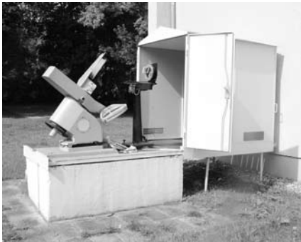
A napfényt az épület belsejébe vetítő cölösztát. A napfényt a kb. a fal síkjában levő lencse gyűjti
