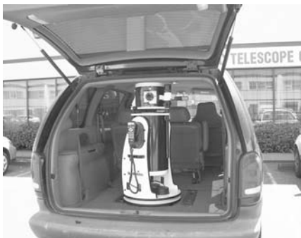
A SkyWatcher 30 cm-es Flex GoTo Dobsonja összecukva, állványostul elfér egy kombi hátsó részében
