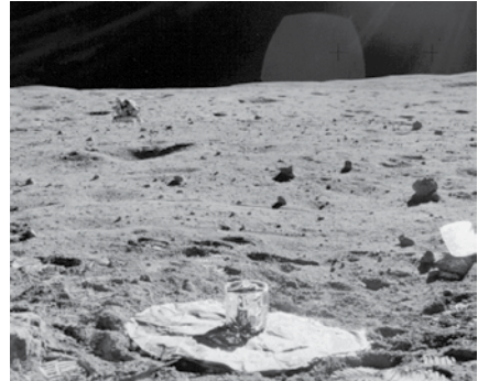
Az Apollo-16 űrhajósaik által kihelyezett Passive Seismic Experiment műszere a kép előterében (Lunar and Planetary Institute)
