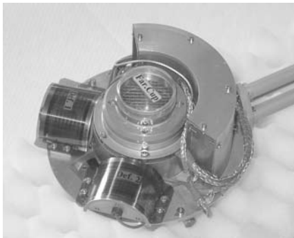
4. ábra. A ROMAP kombinált mérőfeje (Technische Universität Braunschweig)
