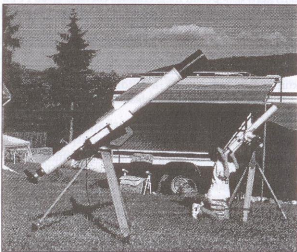
Csukovics Tibor 110/1650-es, Zeiss-objektívvel szerelt refraktora
