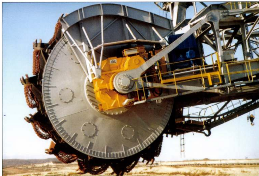
SRs 1300 marótárcsás kotró új meghajtó művel
