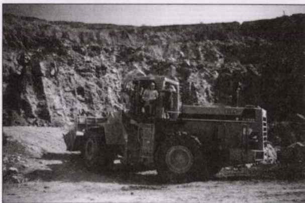
4. kép KOMATSU WA-600-as homlokrakodó (kanala 6 m 3 -es) a + 170 m-es szinten
