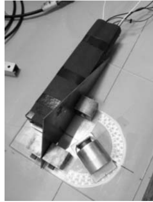
3. ábra. Az elektronszórást vizsgáló mérés összeállítása.
