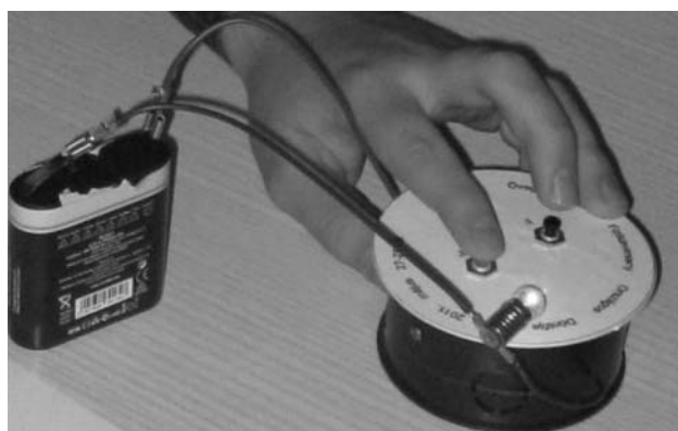
4. ábra. A 2011. évi verseny két nyomógombos „fekete doboza” az zsebtelep-áramforrással és az izzóval.
