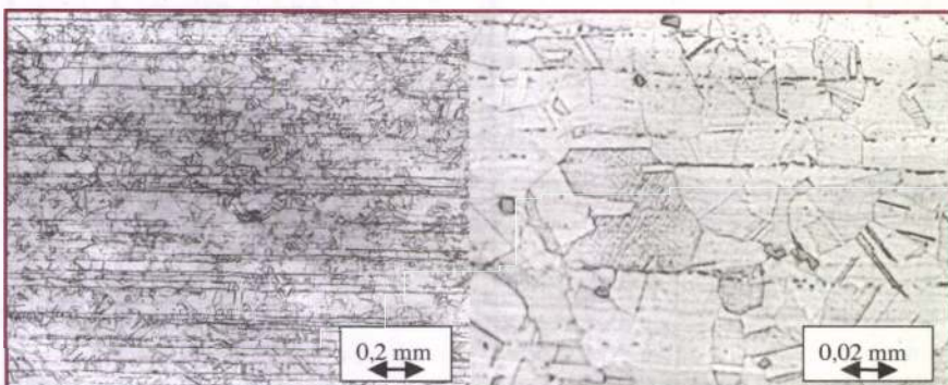
6. ábra. A vizsgálati anyag maratott metallográfiai képe (eredeti nagyítás: 50x, 500x)
