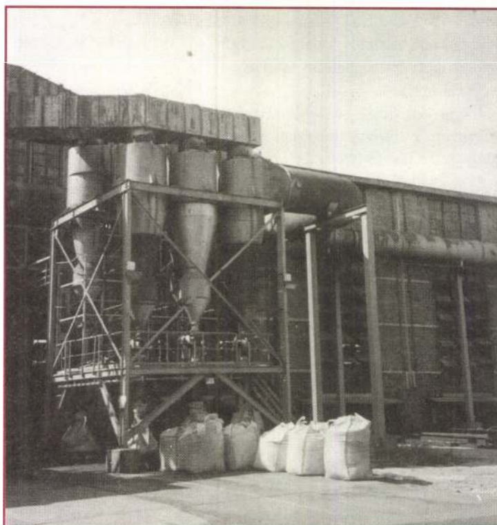
8. ábra. Por előleválasztó multiciklon egység. A leválasztott port big-bag-ekben tárolják
