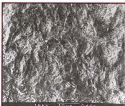
11. ábra. Nagy hőmérsékletű ausztenitizálással és kis hőmérsékletű megeresztéssel nyert bénites vas alapszöveve. a) 200x b) 3200x c) 30 000x
