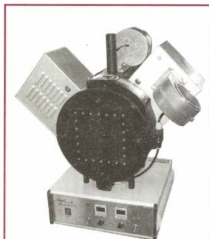
3. ábra. Kétfrekvenciás laboratóriumi kemence (800 W 2,45 GHz / 500 W 5,8 GHz)
