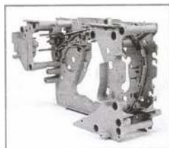
2. ábra. Mélyhúzó-szerszám Kayem-ötvözetből
