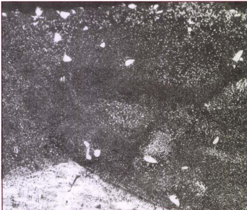
1. ábra. 5% tárcsaforgási sebességgel létrehozott TiC-acél fémmátrixú kerámia-kompozit (MMC) (TiC a felszínen és a rétegben; orig. magn. 100x)
