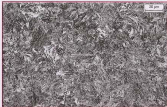
4. ábra. Az 5 és 6 jelű technológiai állapotú anyag mikroszkópos képe. Csiszolatjel: 515. Nitál; eredeti felvétel 500x. Martenzites-bénites alapszövet
