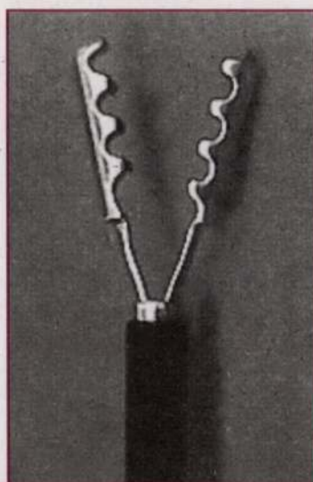
13. ábra. Mikrocsipesz (balra) és az MRI-képe grapefruitban
