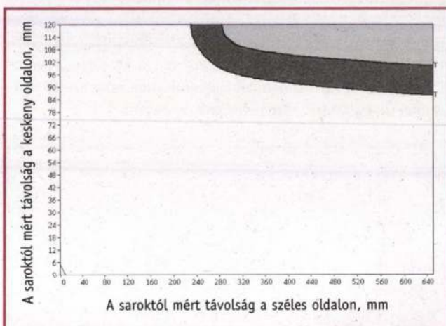
14. ábra. Tócsaalak a keresztmetszet negyedére a kristályosítótól 10,5 méterre (módosított hűtési viszonyok)
