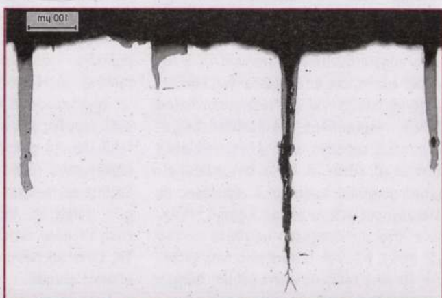
5. ábra. A 213 jelű csiszolaton lévő repedések
