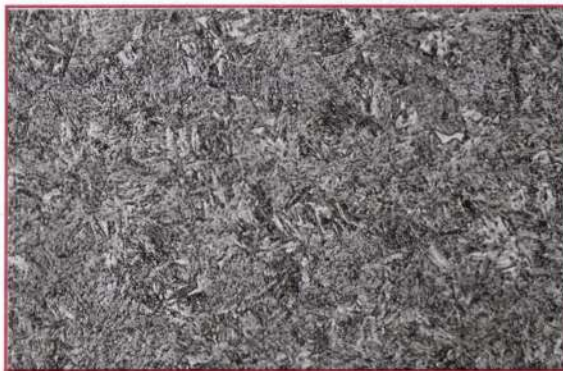
3. ábra. A 2 jelű mintadarab mikroszkópos képe. Csiszolatjel: 412. Nitál; eredeti felvétel 500x. Martenzites alapszövet
