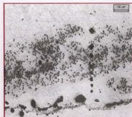
10. ábra. Az epoxigyanta bevonatú karbonszálát tartalmazó darab keménységmérés helyei
