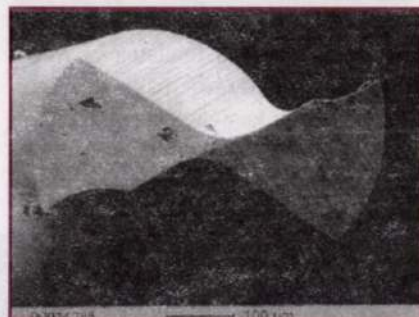
3. ábra. „HAM” keményfém szármaró Ø 600 µm (eredeti nagyítás: 200x)
