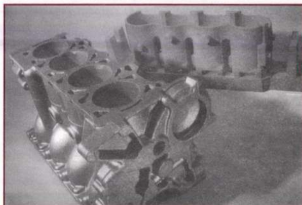
1. ábra. Négyhengeres forgattyúház DCP-eljárással gyártott magja és öntvénye
