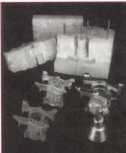
4. ábra. Precíziós öntés sztereolitográfiai mestermintával és szilikon viaszajtoló szerszámmal
