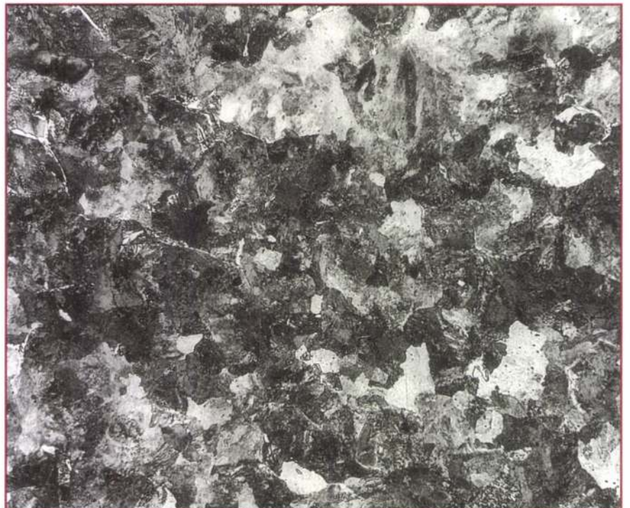
8. ábra. A dilatációs próbatest szövete képe a mérés után N = 800\times
