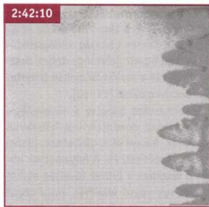
7.b ábra. A cellás-dendrítés szerkezeti változás folyamata
