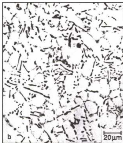
6. ábra. Indirekt squeeze-castinggal öntött AlSi12CuMgNi ötvözet szövete öntött állapotban (a) és T6 hőkezelés után (b). 0,5%-os folyssavval 5 s-ig maratva
