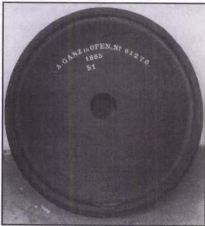
7. ábra. A Ganz Ábrahám öntödéjében 1865-ben készített kéregöntésű vasúti kerék. Öntödei Múzeum, Budapest
