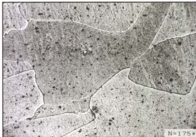
2. ábra. Az 1/3 (0,11% Sn) hengerelt minta, hengerléssel párhuzamos, elektro-polírozott és maratott felületének fénymikroszkópos felvétele
