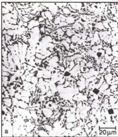
6. ábra. Indirekt squeeze-castinggal öntött AlSi12CuMgNi ötvözet szövete öntött állapotban (a) és T6 hőkezelés után (b). 0,5%-os folyssavval 5 s-ig maratva
