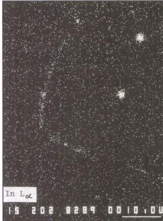
1. ábra A 2/2 (0,15 t% In) öntött minta a) visszaszórt elektronokkal készített felvétele b) In L_{\alpha} karakterisztikus röntgensugarakkal készített elemeloszlási felvétele
