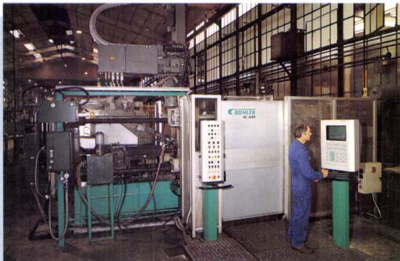
Az SC D/53 gép működés közben a Bühler nyomásos öntödéjében
