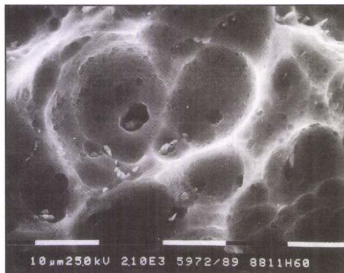
10. ábra. A 60 °C-os, 2 N NaOH oldatban kezelt 1/6 (0,2 t% Sn, 0,23 t% Fe, 0,14 t% Si) hengerelt minta szekunder elektronokkal készített felvétele
