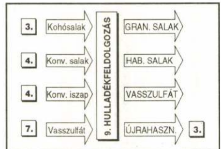
16. ábra. A hulladékfeldolgozás anyagfolyama
