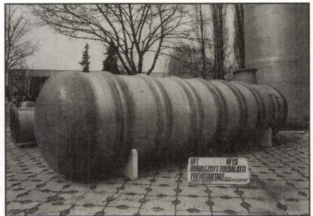
6. ábra. Üvegszál/poliészter anyagú, tekercselt és bordázott testű, földalatti fekvőtartály
