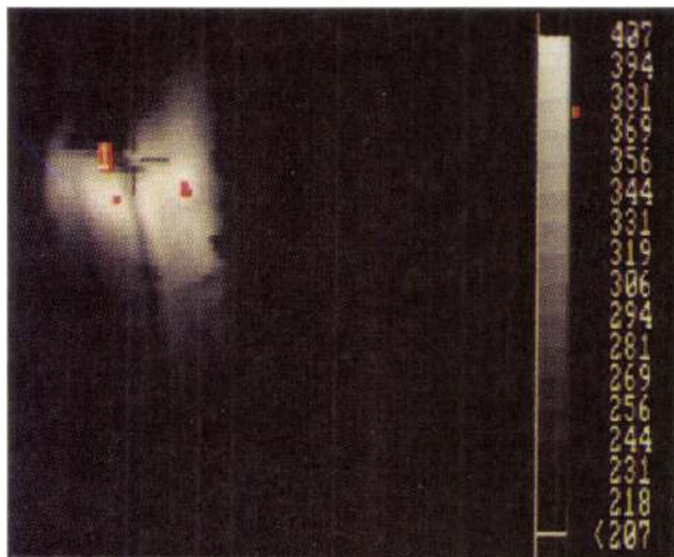
8. kép. A nyersvaskeverő csőrének bal oldalán felvett hőmérsékleti térkép
