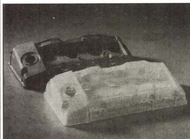
3. ábra. Hengerfejedél sztereolitográfiával készült mintája és egy ilyen gyártott alumíniumöntvény
