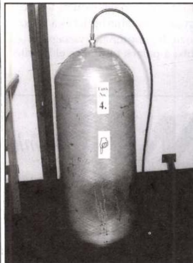
3. ábra. A gázpalack kisciklusú fárasztása után jelentkező meghibásodás „szivárgás repedés előtt” formájában
