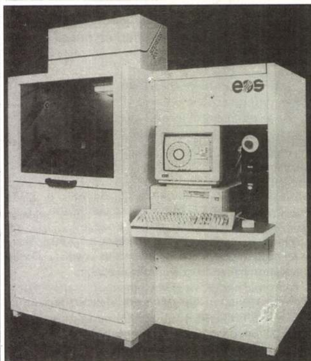
2. ábra. A STEREOS nevű sztereolitografáló berendezés prototípusok gyártásához
