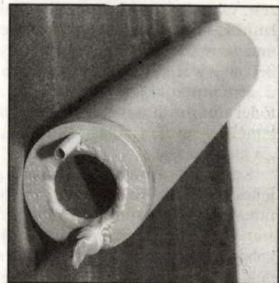
3. ábra. Homogén hőmérséklet-eloszlású fűtőcső csökemencéhez
