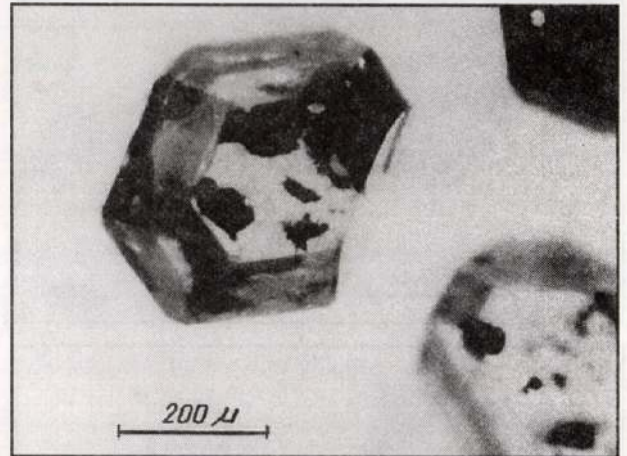
9. ábra. A B típusú, 30/40 mesh szemcseméretű szintetikus gyémántok mikroszkópos felvételei 1180 °C hőmérsékletű, 20 perces időtartamú, semleges gázban történt hőkezelés után. Felső sor: változatlan kristályok. Középső sor: sötétedett és szélesedett zárványokkal rendelkező kristályok. Alsó sor: Sötét kristályok.
