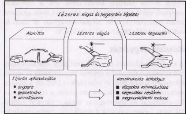
4. ábra. Lézersugaras vágás és hegesztés együttes alkalmazása
