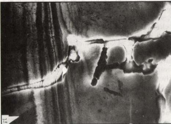
2. ábra Az 530 °C-on 3 órán át hőkezelt AlMg4.5Mn minta jellegzetes, kis nagytávú, elektronmikroszkópos képe
