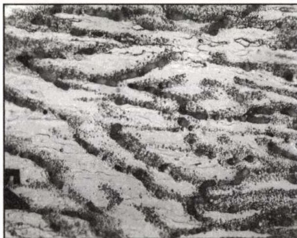
5. ábra Az Al99,5 anyag 500 °C hőmérsékleten hengerelt, majd azonnal lehűtött próbájának szövete. Nagyítás 540-szeres.
