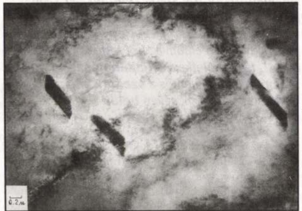
4. ábra Az 530 °C-on 6 órán át hőkezelt AlMg4 mintában detektált jellegzetes „hosszúkás” alakú szekunder fázisok elektronmikroszkópos képe
