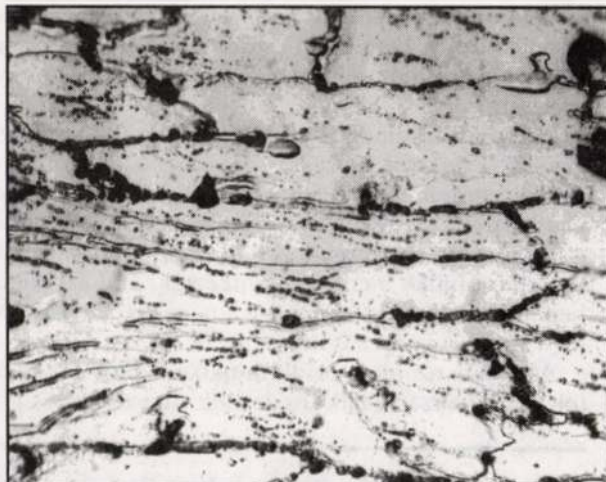
6. ábra Az AlMn anyag 344 °C-on hengerelt és 60 mp-ig hűtő tartott próbájának szöve. Nagyítás 540-szeres.
