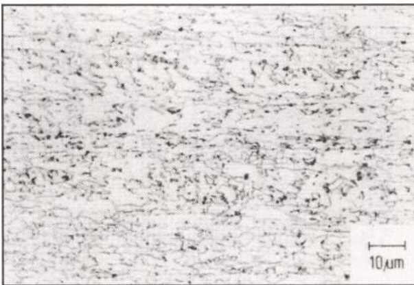
10. ábra. PAS 70 jelű melegen hengerelt szélesszalag jellemző szövete képe
