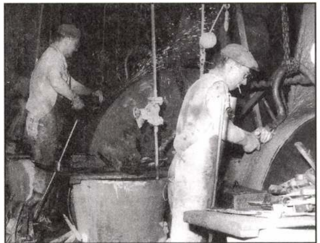
2. ábra. Csákányok köszörülése a vizesköszörős-műhelyben
