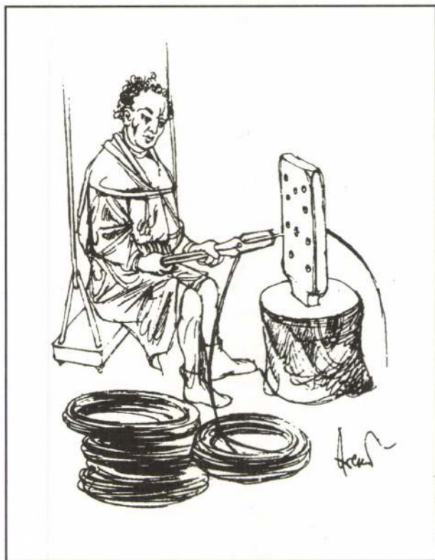
4. ábra. Emberi erővel működtetett hintázó dróthúzó
