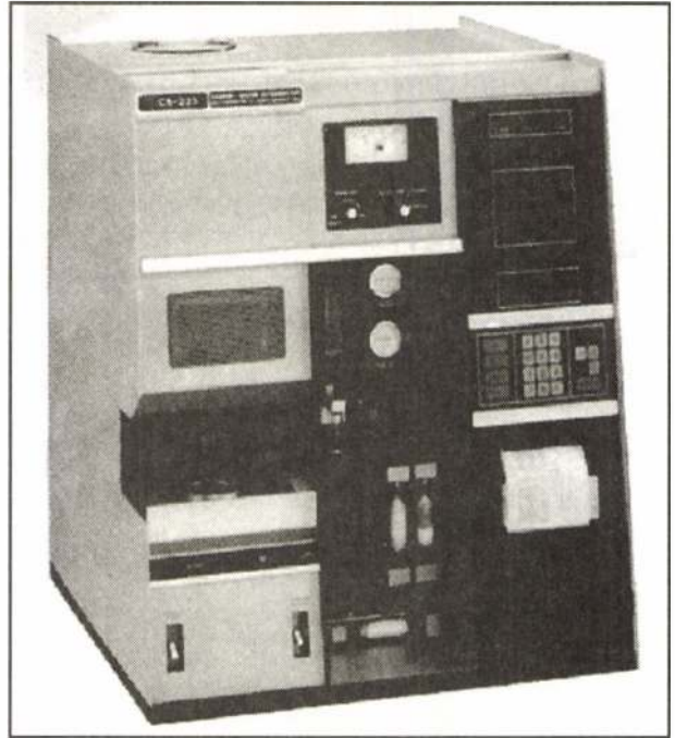
2. ábra. A Leco Instruments GmbH karbon- és kénelemző berendezése
