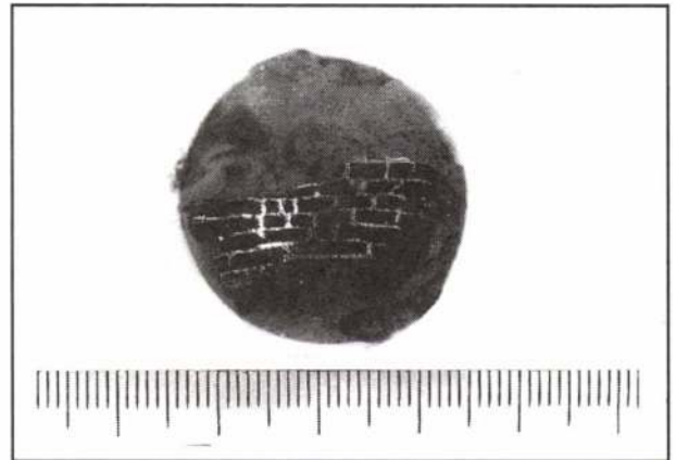
4. ábra. A préselmény hosszanti csiszolata (2-szeres nagyítás)
