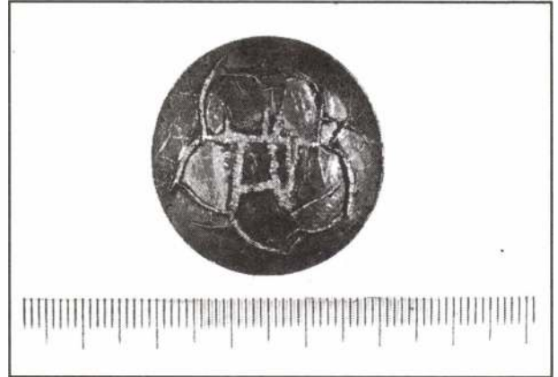
3. ábra. A préselménynek a tárcsák síkjával párhuzamos keresztcsiszolata (2-szeres nagyítás)
