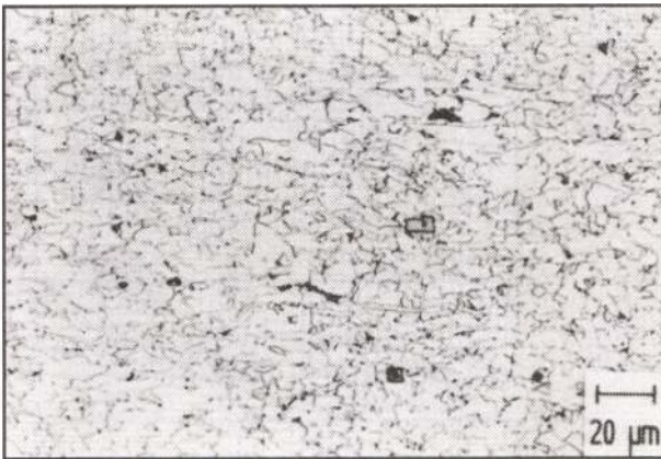
9. ábra. QSTE 500 TM jelű melegen hengerelt szélesszalag jellemző szövete képe
