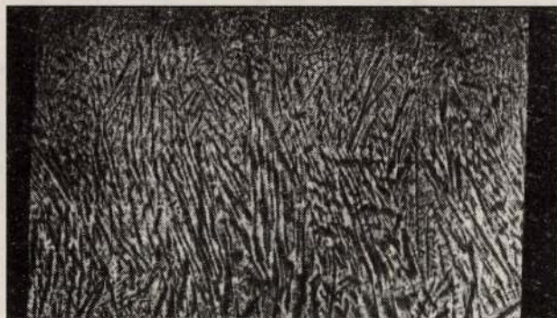
10. ábra. Az öntött buga jellegzetes primer szerkezete Oberhoffer-féle maratás után (N=3,5)
