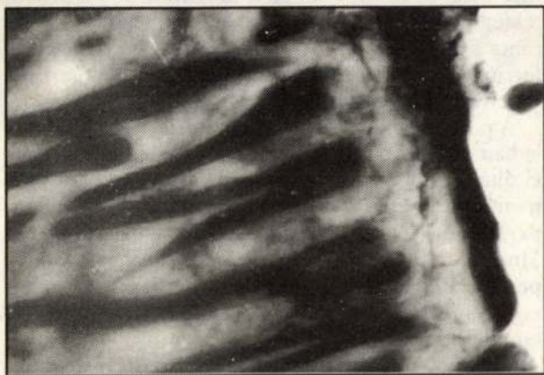
18b. ábra. A perlit cementitlemezkéitől független cementitfilmről készített transzmissziós elektronmikroszkópos felvétel (N=20 000x)
