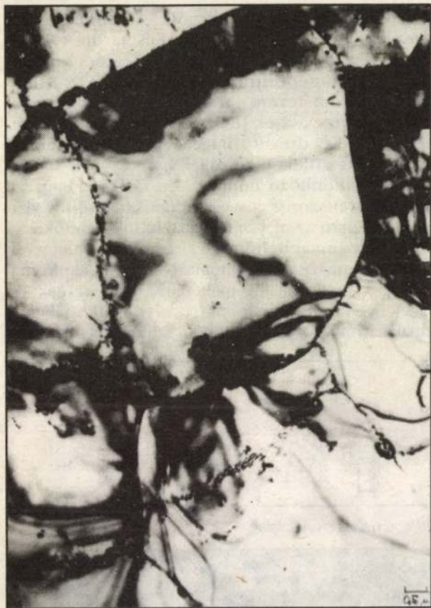
13. ábra: Alacsony hőmérsékletű sávban hengerelt huzal
