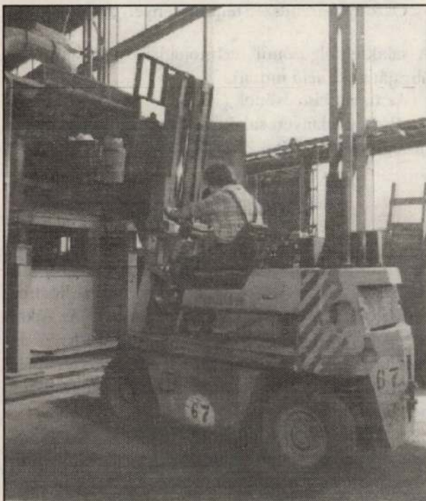
2. ábra: Salaküst feladása a hűtősor elejére.
