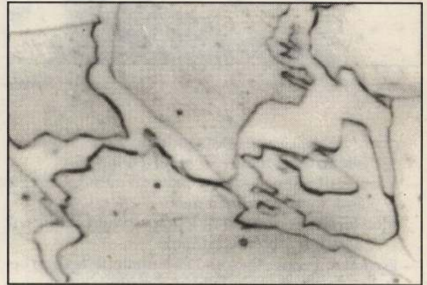
2. ábra. Vaskos cementitfilm lágyacél ferrit szemcsehatárai mentén (N=2000x)
