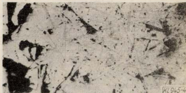
4. ábra. A jósfafői salak vékonycsiszolata. N=200x
