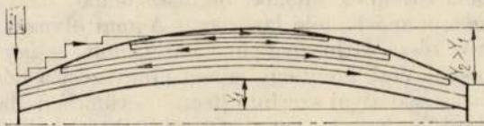
2. Pozitív domborítású henger átköszörülése kisebb pozitív domborításúra
