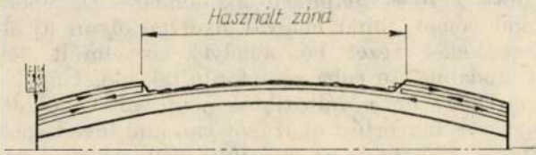
1. Kapott henger pozitív domborítású ujraköszörülése
