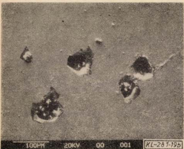
19. ábra. A kronopotenciosztatikus vizsgálatoknak alávetett minták felületén kialakult pittingekről készített pásztázó elektronmikroszkópos felvételek
