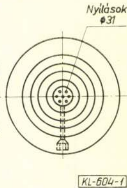
1. ábra. A mélykemence szabályozható hosszirányú és formájú lángcsóvával rendelkező égetőberendezése 1 — segédfűvőka, 2 — égő, 3 — égőalagút
