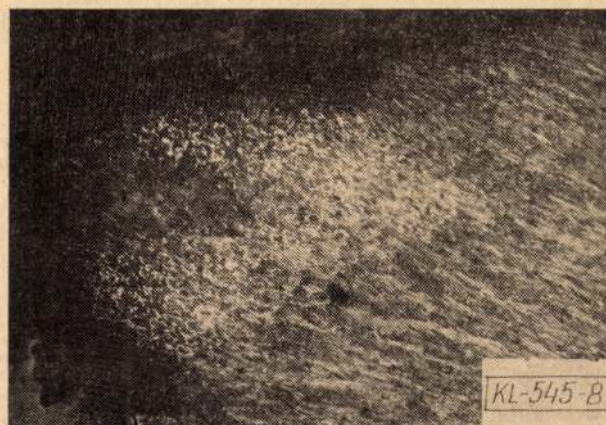
8. ábra. A dúslult részben bekövetkezett kúpos szakadás N = 50 \times (4\% \text{-os pikrinsav})
