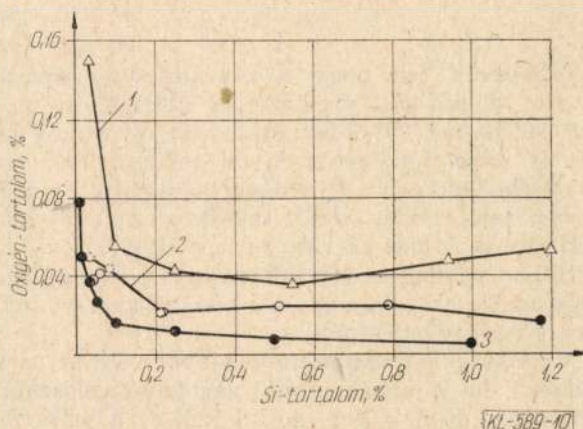
10. ábra. A dezoxidáló ötvözet hatása az Armco-vas összes oxigéntartalmára 1600 °C-on a Si-tartalom függvényében [16] 1: FeSi 52 %, 2: FeSiMn (21/58 %), 3: közel egyensúlyi állapot
