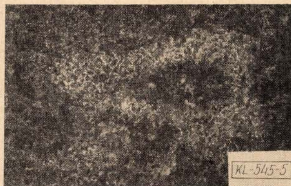
5. ábra. Dúsulás a szabályozott hűtéssel hengerelt huzal közepében N = 80 x (4 %-os pikrinsav)
