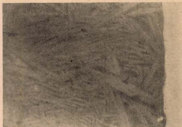
18. ábra. Rhodonit kristályok cső buga lunkerporsalak zárványában. N = 400 \times .
