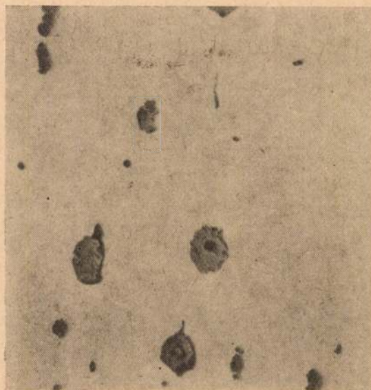
10. ábra. Gömbalakú tűzállóanyag zárványok 0,50% C tartalmú ötvözetlen acélban. N = 150 \times .
