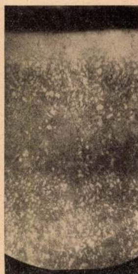
4. felvétel. „A'' ötvözet 60% \text{N}_2 + 40% \text{NH}_3 gázkeverékkel nitridálva. Nagyítás 100 ×
