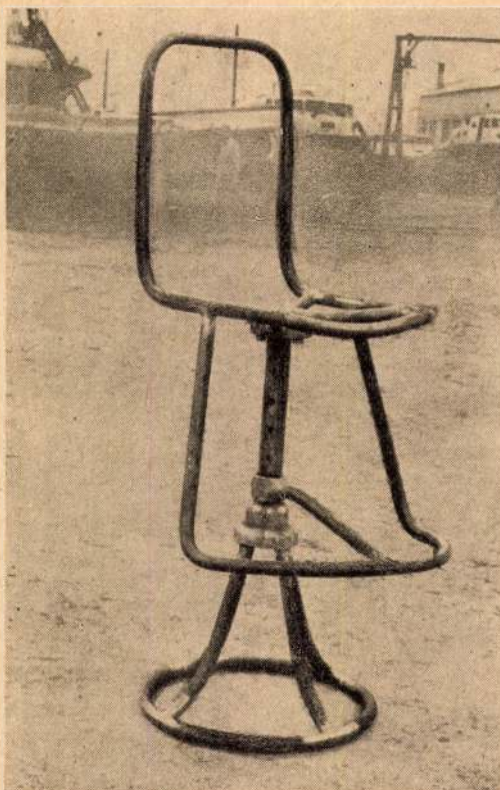
25. ábra. Hegesztett csőszék (hajóvezető ülés váza)
