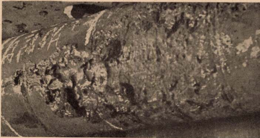
3. ábra. Pakuraláng okozta kimaródás öntecs felületén
