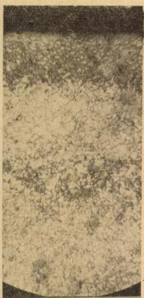
6. felvétel. „A'' ötvözet 80% \text{N}_2 + 20% \text{NH}_3 gázkeverékkel nitridálva. Nagyítás 100 ×
