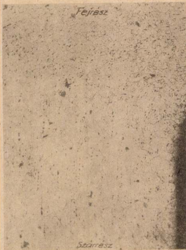
12. ábra. Lágy D18 összetételű szegecshuzalból előállított szegecs szövete, nemesítés után. 75 ×
