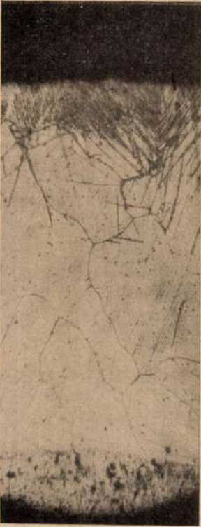
9. felvétel. „B” ötvözet 60%-ban disszociált NH_3 gázzal nitridálva. Nagyít- tás 100 ×
