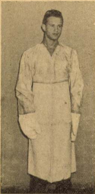
8. ábra Fémszűrővel alumíniumozott vászonzól készült nagykötény és mellény és fémszűrővel fedett azbesztkesztyű. A kötény és mellény együttes súlya 1,37 kg
