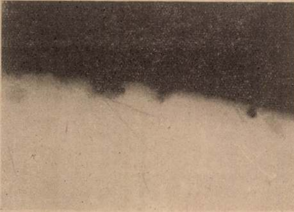
17. ábra. Homogenizáló izzítás után gyorsan lehűtött D18 ötvözetű huzal csiszolata, sóspermet-kamrában történő 15 napos kezelés után (maratlan, 150×).
