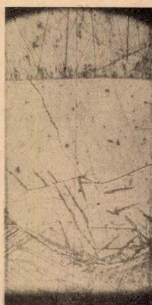
8. felvétel. „B'' ötvözet 40% \text{N}_2 + 60% \text{NH}_3 gázkeverékkel nitridálva. Nagyítás 100 ×
