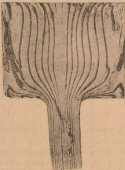
6. ábra. A koordináta-háló-rendszer változása a duralumín ( D_l ) direkt sajtolásánál ( D_k = 40 \text{ mm} , D_e = 10 \text{ mm} , L = 70 \text{ mm} , t_s = 400 \text{ C}^\circ ).
