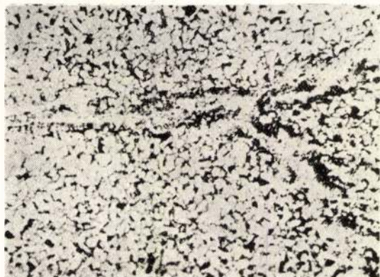
10. ábra. Felszín alatti összeforrott hólyagok. 100x. Hosszmetset.
