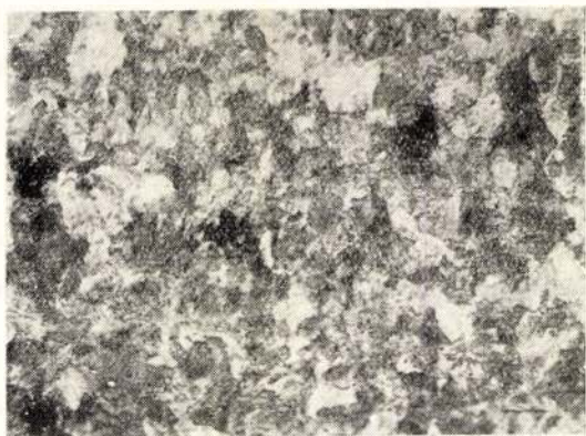
2. ábra. Oxidsalakzárványok 0,8% C-tart. patentesztelt acélhuzal, 1% HNO 3 -alk. 500x. Hosszmetszet.
