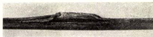
11. ábra. a) Behengerelt ráfolyás. 4,8 mm \varnothing , 140 kg/mm 2 szak. szil. acélhuzal. Oxidsalakzárványok. Maratlan. 10x. Keresztmetset. b) Behengerelt ráfolyás, hajlításnál felnyílt. 1x.
