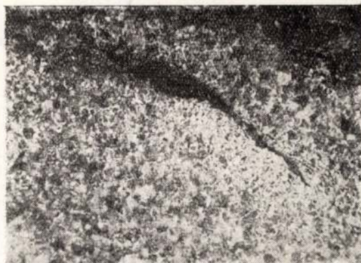
27. ábra. Felületi széntelenedés behengerelt oxidzárványmentén. 0,8% C hengerhuzal, 1% HNO 3 -alk. 100x. Keresztmetszet.
