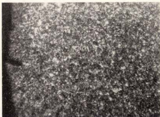
8. ábra. Húzásnál felnyílt gázhólyag okozta felületi hosszrepedés, 1% HNO_3 -alk. 100x. Keresztmetszet.
