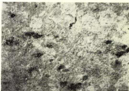
3/a. ábra. Cr-oxid salakzárványok. 0,8% C-, 0,19% Cr-tart. patentesztelt acélhuzal. 1% HNO 3 -alk. 500x. Hosszmetszet.
