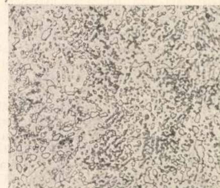
5. ábra. 0,9 % C tart. acél. Szemesés perlit. (1000-szeres)
