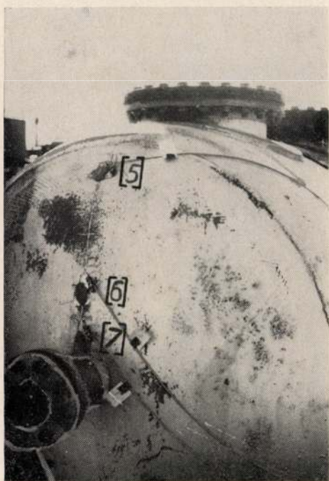
4. ábra Az 5—7 jelű nyúlásmérő bélyegek helyei
