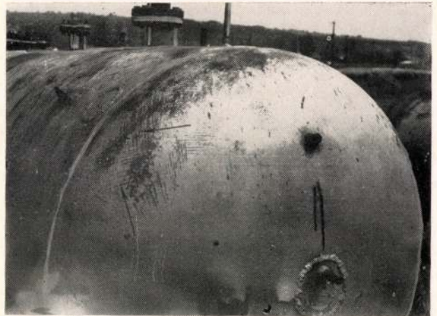
2. ábra A VI jelű edényfenéken 56 att nyomáson észlelt főfeszültségi trajektóriák
