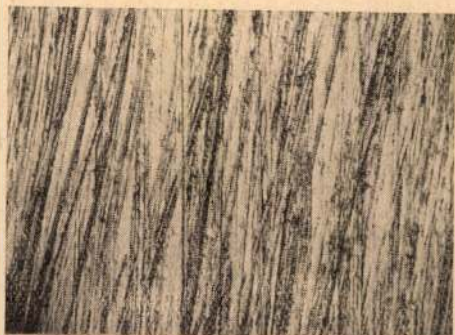
6. ábra. A kísérleti kokilla felülete bemártás előtt
