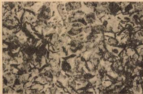
19/c ábra. 18/c ábra szövete képe. (Maratva HNO_3 , 600\times )
