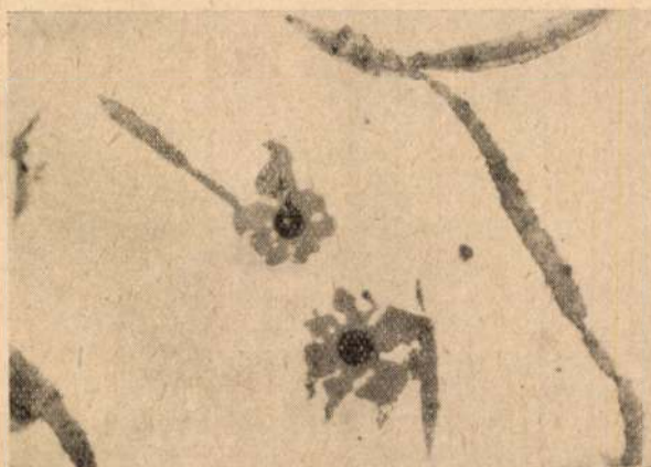
7. ábra. a) Cseppalakú üveges képződmény MnS belsejében a 17. próba szövetejében. Maratlan, fehér fény, N = 1000 ; b) Az előbbi felvétel polarizált fényben keresztezett Nikoloknál
