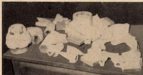
21. ábra. Vízüveg-szénsavas kötésű formázóanyaggal készült kényes vasöntvények és annak magjai
