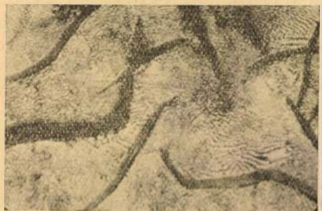
19/a ábra. 18/a ábra szövetképe. (Maratva HNO 3 , 600 ×)
