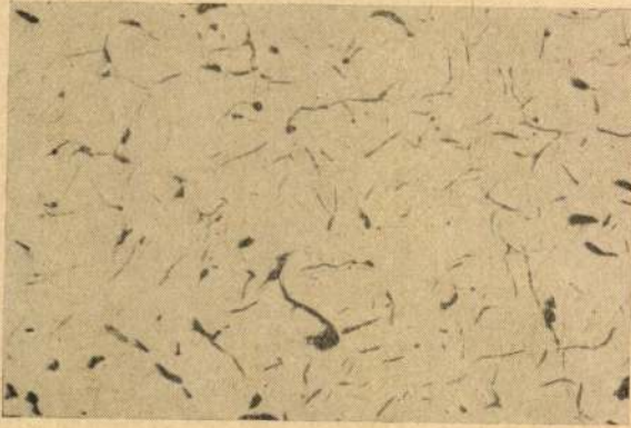
5. ábra. M. 35. kategória 0,8% CaSi + 0,1% FeB a) grafítkép 100×, b) szövetcép 300× 3% alk. HNO 3
