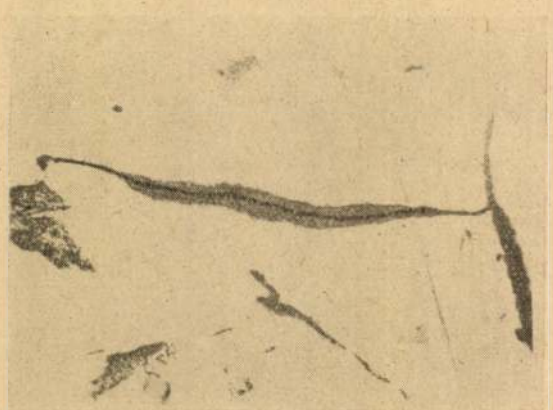
4. ábra. Marógép állvány anyaga. Gyártotta: R. M. Öntödegyár. Deformációs maratás. 700 ×
