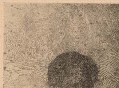
12. ábra. Elektronos kezeléssel gg. finomheng. I. öntöde. Si = 1,22% \sigma_B = 37,6 \text{ kg/mm}^2 \times 200
