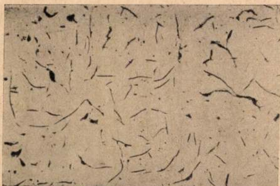
7. ábra. M. 35. kategória 0,8% CaSi + 0,5% FeB a) grafitkép 100×, b) szövetskép 300×, 3% alk. HNO 3
