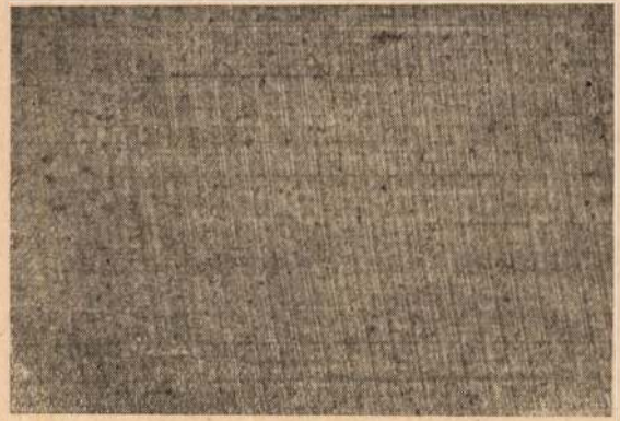
16. ábra. Hálós elrendezésű cementit. Lúgos nátriumpikrát. 50×
