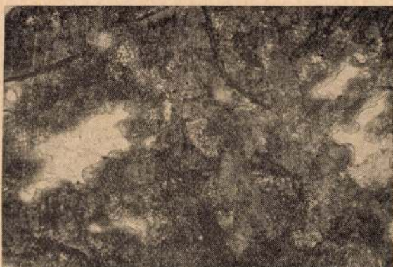
7. ábra. M. 35. kategória 0,8% CaSi + 0,5% FeB a) grafitkép 100×, b) szövetskép 300×, 3% alk. HNO 3
