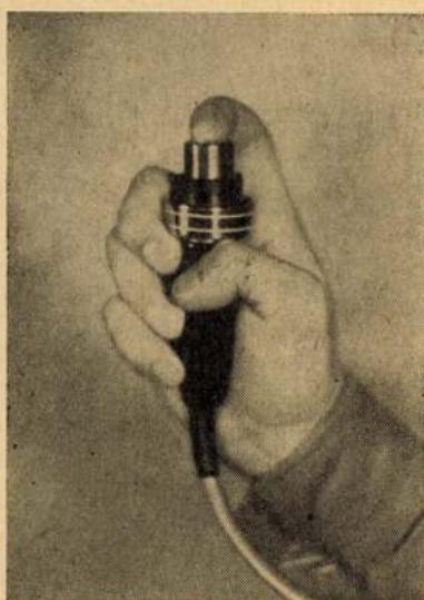
6. ábra. A csillapítás-vizsgálat módja kisméretű próbatesten ultrahanggal.
