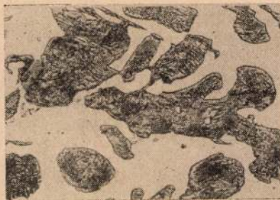
22. ábra. Normálminőségű hengeranyag a) a hőkezelés előtt. x 300, b) 72 h —550° hőkezelés után, maratlan x 50, c) ugyanaz maratva x 300
