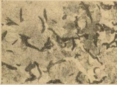
13. ábra. Hengeranyag a II. öntödéből. Si = 1,91\% ; \sigma_B = 27,4, \text{ kg/mm}^2 \times 200
