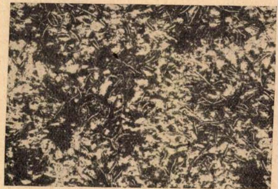
13. ábra. Kis foszfortartalmú szürkeöntvény felület mélymaratott képe. 3% Alk. HNO 3 . 20 \times
