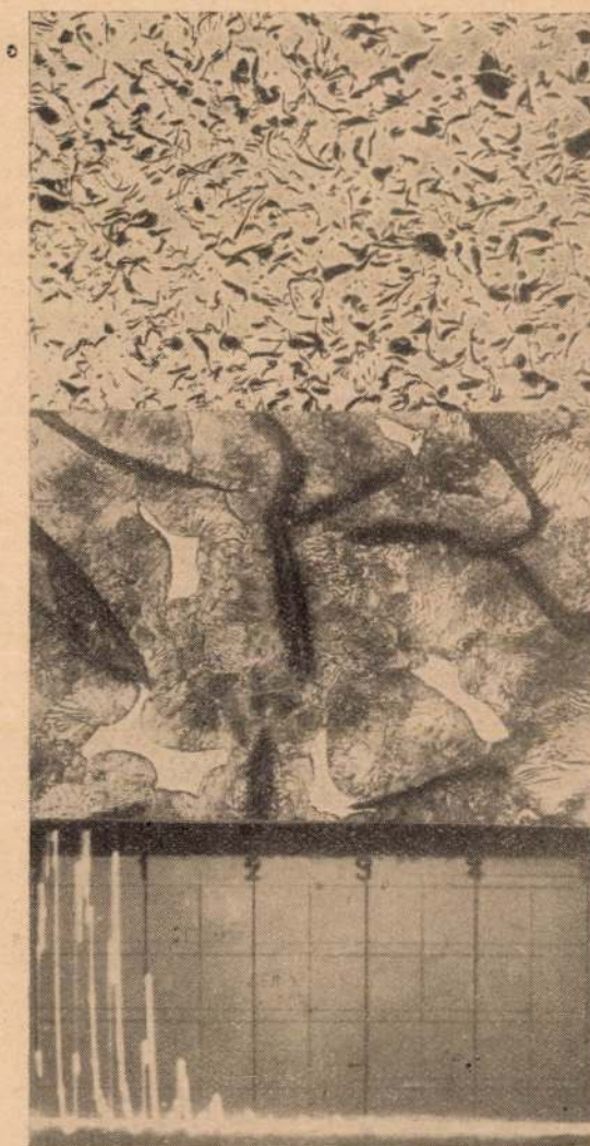
15. ábra. M28-as minőségű esztergapad ágy-szán. a.) grafitkép 25 \times , b) szövatkép 250 \times , c) csillapítási görbe.
