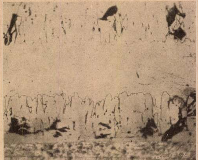
3. ábra. Tűzi alumínizálással bevont acéllemez metszete. A lemez 730—740 C°-on 50 mp-re lett kohóalumínium fürdőbe mártva. Diffúziós réteg vastagsága 50 és 170 mikron között változik. 300×
