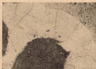
26. ábra. Félkemény trió-henger anyaga. Si = 2,28%, \sigma_B = 33,6 \text{ kg/mm}^2 \times 300
