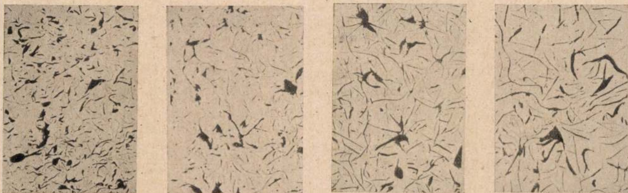
14. ábra. A grafit alakjának a változása az S tartalomtól függően
