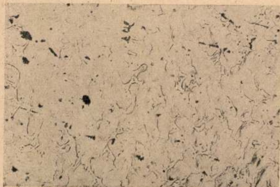
4. ábra. M. 35. kategóriai alapanyag a) grafitkép 100 ×, b) szövetség 300 ×, 3% alk. HNO 3
