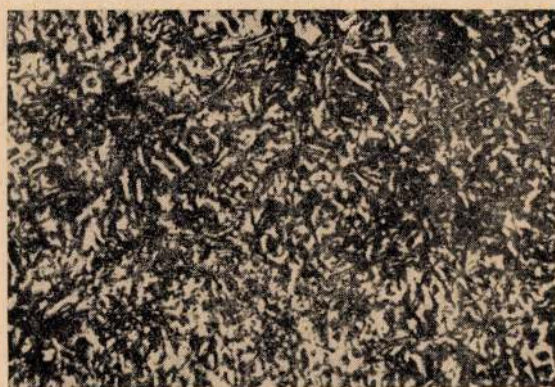
11. ábra. „Cincinnati” tengelyköszörű csúszóvezetéke. 4×
