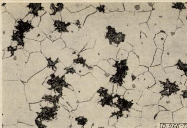
7. ábra. Kis hőmérsékleten temperált próba szövetekepe. Nital, 200X
