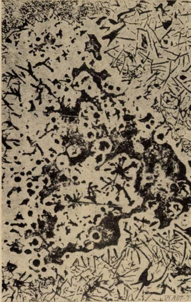
7. ábra. Ritkaföldfémekkel alulkezelt öntöttvasban kialakult gömbgrafitos-ledeburitos terület szövetképe, N=75\times
