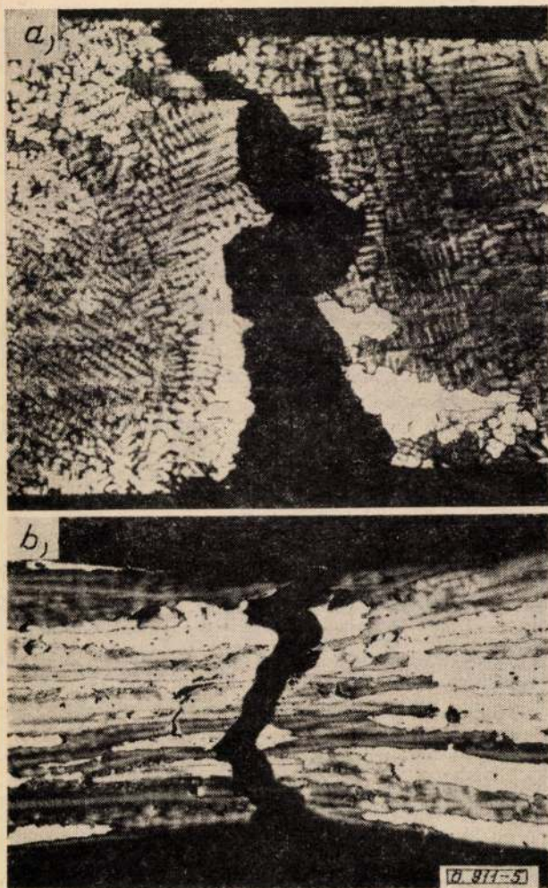
5. ábra. Hagyományosan öntött (a) és irányítottan dermedt (b) próbatest szakadási helye. 20 ×
