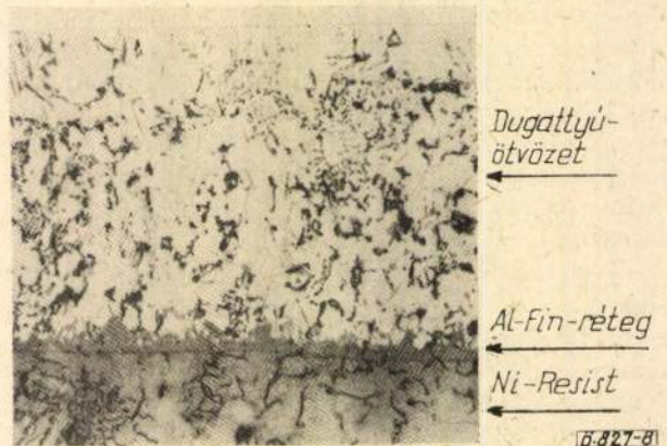
8. ábra. Fogszerű bemélyedések nélküli Al—Fin-réteg Ni—Resist és Al—Si dugattyúötvozt között [12]
