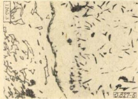
6. ábra. Az Al_4C_3 -tűk (jobb oldalt) és a ledeburitos szövet (bal oldalt) között keskeny zóna van. N = 750 \times [10]
