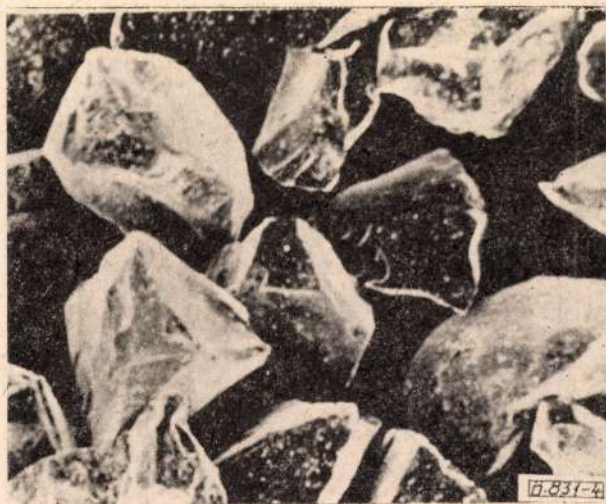
4. ábra. A cirkónium-szilikát elektronmikroszkópos felvétele. 1000 \times
