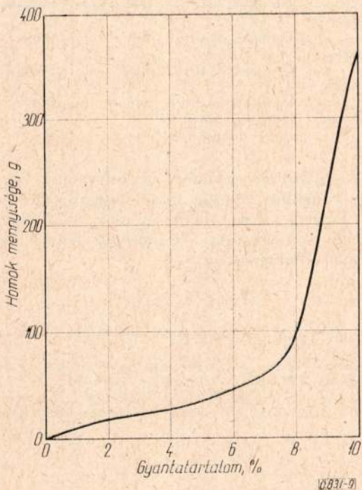
9. ábra. A koptatószilárdság változása a gyantatartalom függvényében. TP20H : T1 \alpha = 1 : 1
