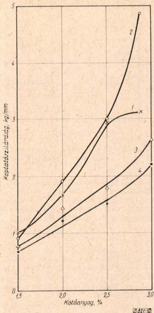
10. ábra. Denaturált szeszes fekecs koptatószilárdsága a kötőanyag-tartalom függvényében
