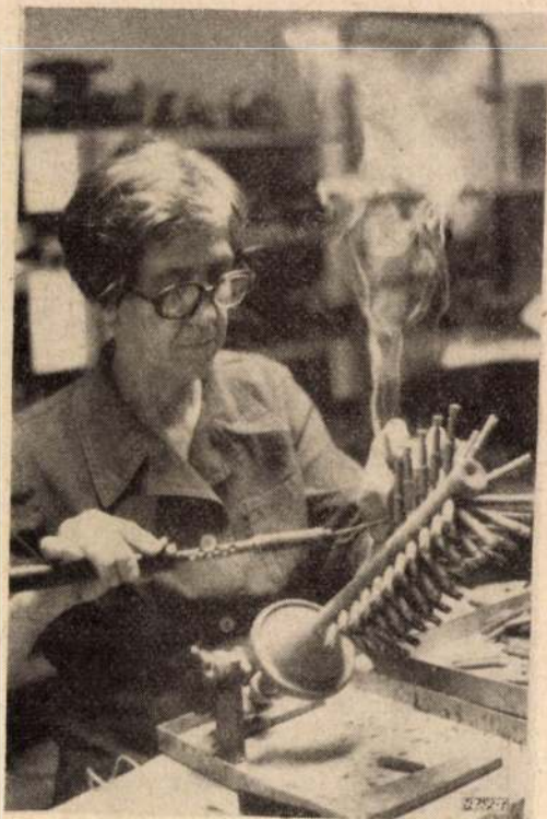
1. ábra. Viaszminták bokrosítása. Makk László felvétele
