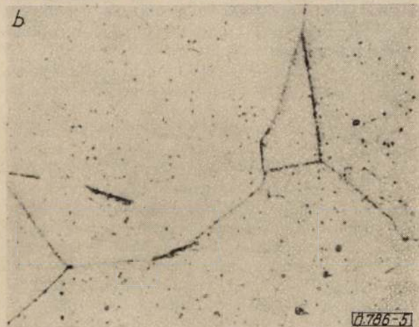
5. ábra. Az 1/a eljárással előállított ötvözet szövete képe a — öntés után, N = 100\times , b — hőkezelés után, N = 500\times
