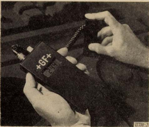
3. ábra. PVP típusú digitális műszer nyers formák tömörségének méréséhez
