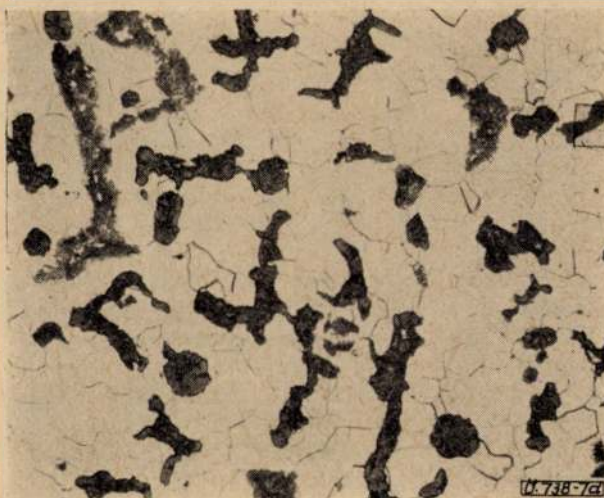
7. ábra. Az 1. sz. öntöttvas szövetekepei a — 4000 °C/min, b — 1400 °C/min, c — 8,0 °C/min, d — 2,0 °C/min lehülési sebesség. N = 300 \times
