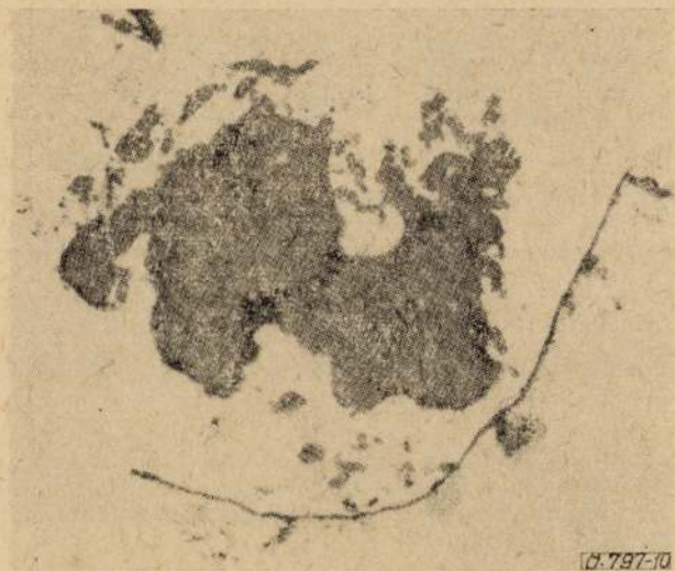
10. ábra. Nagy, amorf szilikátzárvány oxidhárttyával. 200 \times
