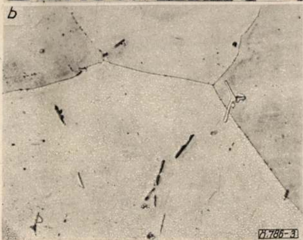
3. ábra. Az 1/b eljárással előállított ötvözet szövetképe a — öntés után, N = 100 ×, b — hőkezelés után, N = 500 ×
