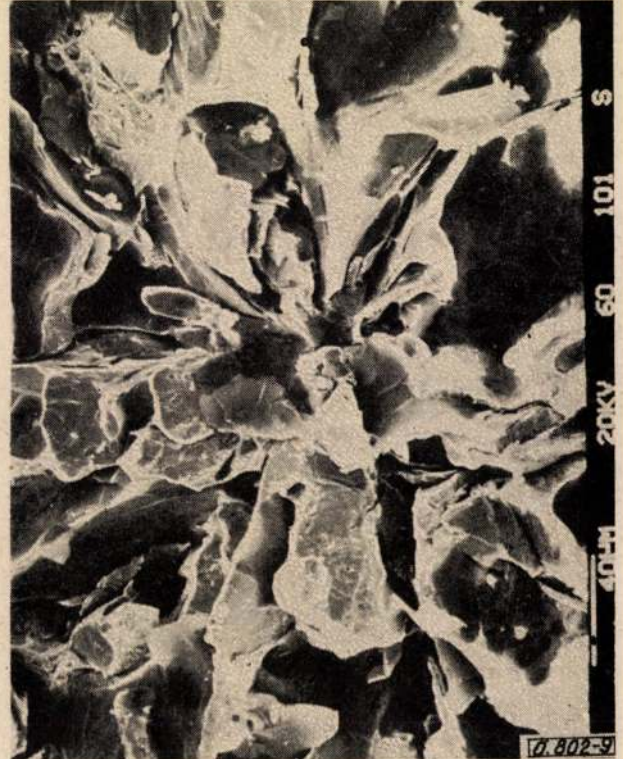
9. ábra. A perlités, lemezgrafitos, kezeletlen (3.1 jelű) próba szövete képe (250×) és törési felülete
