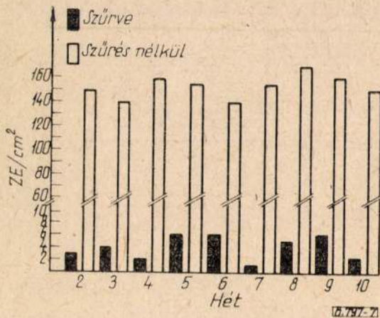
7. ábra. A szűrés hatása a tisztasági fokra
