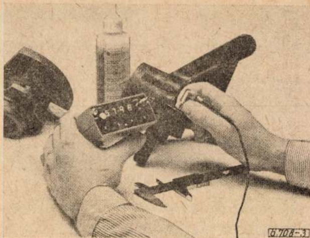
3. ábra. A Krautkrämer cég ultrahangos készüléke vasöntvények ellenőrzésére
