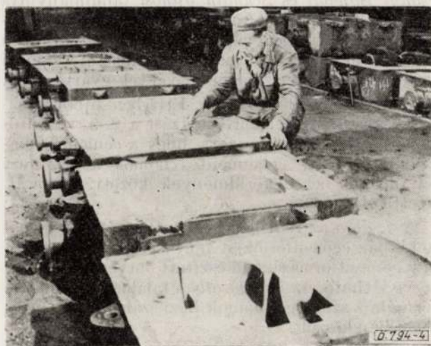
4. ábra. Orsófej és fogaskerékház cementformája
