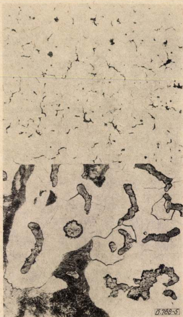
5. ábra. Az 545. sz. próba grafit- (100×) és szövete képe (300×)
