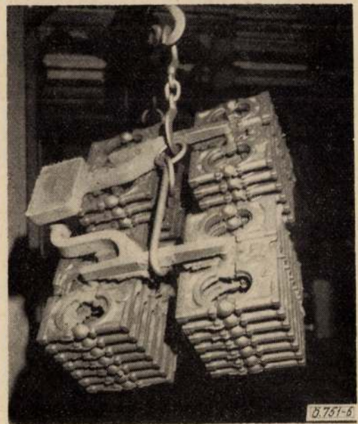
6. ábra. Fürtöntéssel készített főcsapágyfedelek
