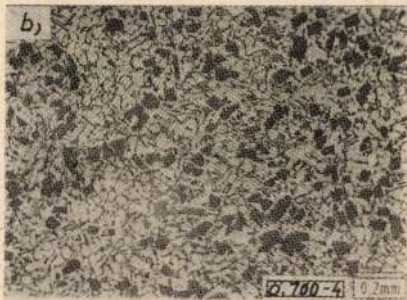
4. ábra. A GK-AlSi12CuMgNi ötvözet szövete kezeletlen állapotban (a) és 0,3% CuP6,5 huzallal régzett szemeseffinómítás után (b)
