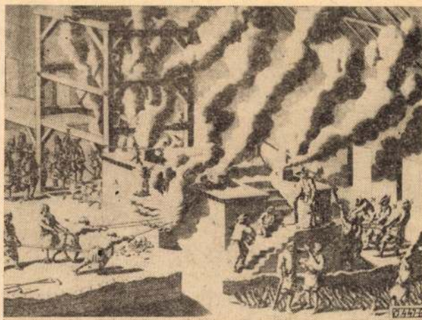
6. ábra. Bronzágyú öntése a XVII. század végén (Survivey de Saint Rémy, 1697)
