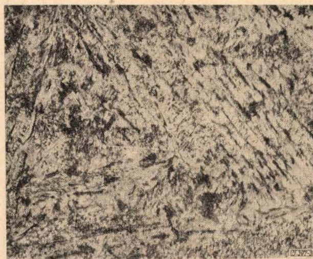
3. ábra. A K14 szerszámacél (1050°C-ról olajban hűtve, 620°C-on megeresztve) szövetszerkezete. N=3000\times
