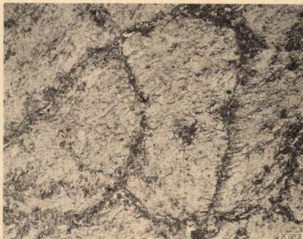
2. ábra. A K14 szerszámacél (1050°C-ról levegőn hűtve, 620°C-on megeresztve) szövetszerkezete. N=3000\times
