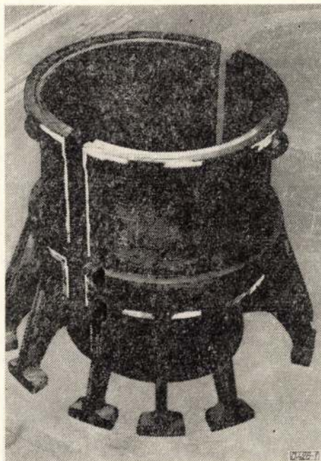
4. ábra. Gázturbina sűrítő-kilépőháza SF400 gömbgrafitos Meehanite-öntöttvasból
