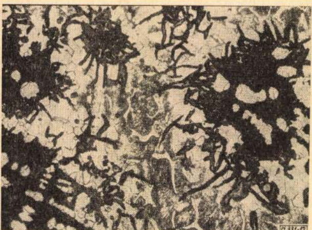
12. ábra. 900 °C-on hőkezelt öntvény szövetképe középen. N = 300 ×
