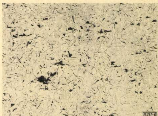
6. ábra. A grafit megjelenése az öntvény közepén. N = 100 \times
