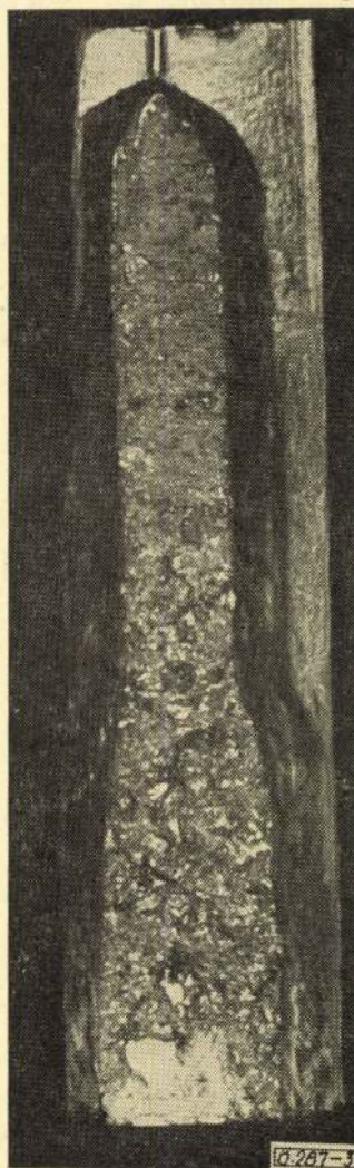
3. ábra. Vasdúsulás a töretben
