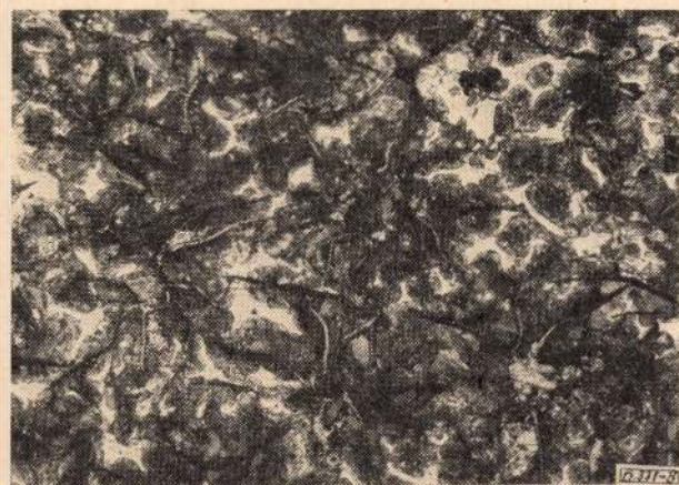
8. ábra. A nyers öntvény szövete középen. N = 300 \times
