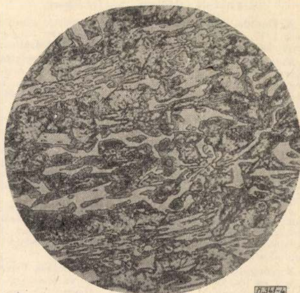
4. ábra. Eutektikus Ni-Hard ötvözet szövete hőkezelés után (hőntartás 750^\circ\text{C} -on 8 h, lehűtés levegőn). 2%-os alkoholos \text{HNO}_3 , N = 300 \times
