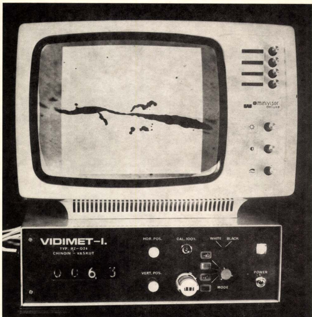
A Vasipari Kutató Intézetben kifejlesztett VIDIMET-I. anyagvizsgáló berendezés
