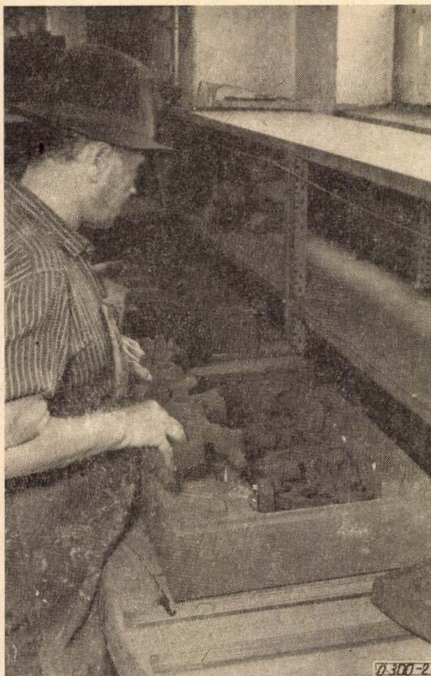
2. ábra. Egy magforma összerakása a konvejonon
