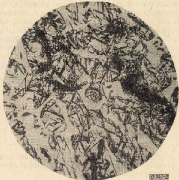
2. ábra. A megengedettnél több szilíciumot tartalmazó Ni-Hard ötvözet szöve (martensit, karbid, maradék austenit, grafit). HRC 50. 3%-os alkoholos HNO 3 , N = 300 ×
