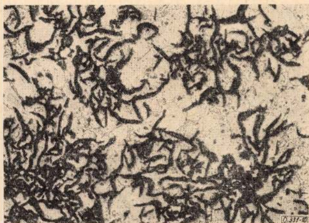
10. ábra. 850^\circ\text{C} -on 9 percig hőkezelt öntvény szövete középen. N = 300 \times
