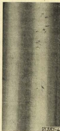
3. ábra. Vasdúsulás a töretben
