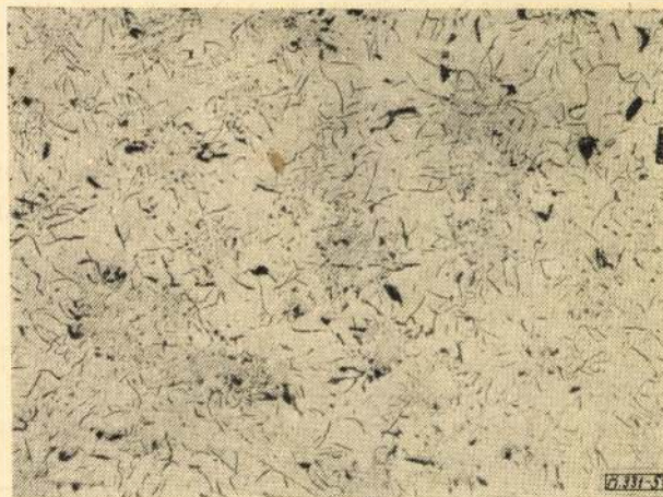
5. ábra. Az öntvény zománczásra kerülő felületének közelében található grafit. N = 100 \times
