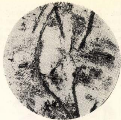
11. ábra. 19 jelű öntés mikroszerkezete. 30 mm, 550 X.
