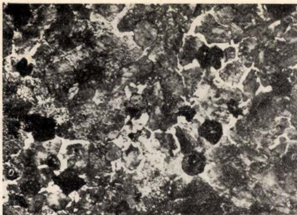
30. a) és b) ábrák. 74 kísérlet hőkezelve 2% \text{HNO}_3 , \times 105 III. \times 385 .
