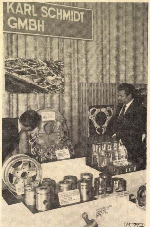
4. kép. A Karl Schmidt cég kisnyomású eljárással készült járműöntvényei
