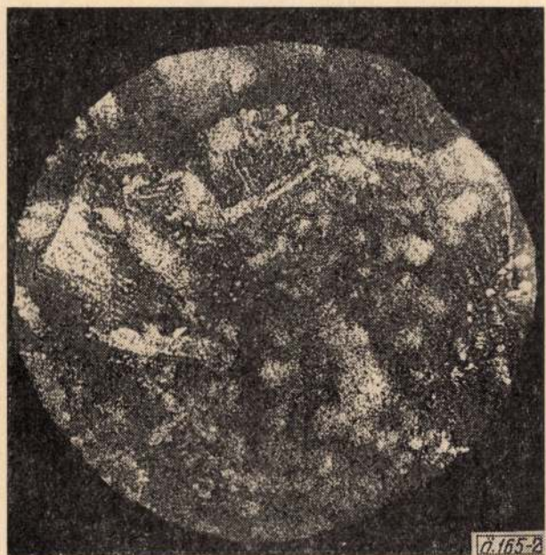
2. ábra. Acéltöret mikroszkópi képe 50-szeres nagyításban. Kerpely Antal felvétel utáni rajza (1877) [6]
